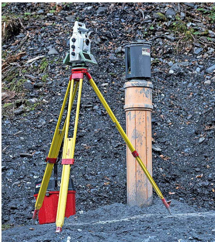
Massnahme zur Arbeitssicherheit: Mit einem Tachymeter (rechts im Bild) können mittels Lasertechnik Deformationen an der instabilen Sperre Acht rund um die Uhr erfasst werden. Bei Überschreitung definierter Grenzwerte wird ein Alarm ausgelöst.
